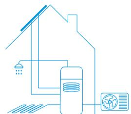
Console carrossée avec ballon ECH<sub>2</sub>O intégré
