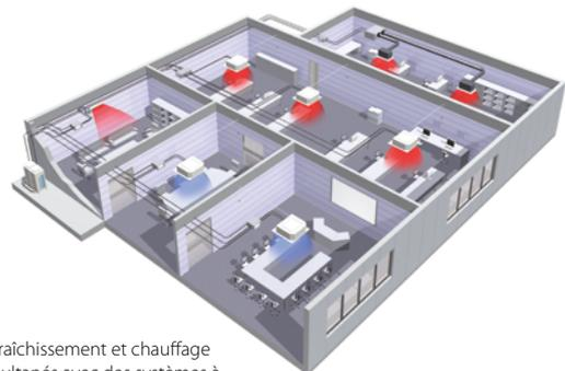
Rafrâichissement et chauffage simultanés avec des systèmes à récupération d'énergie
