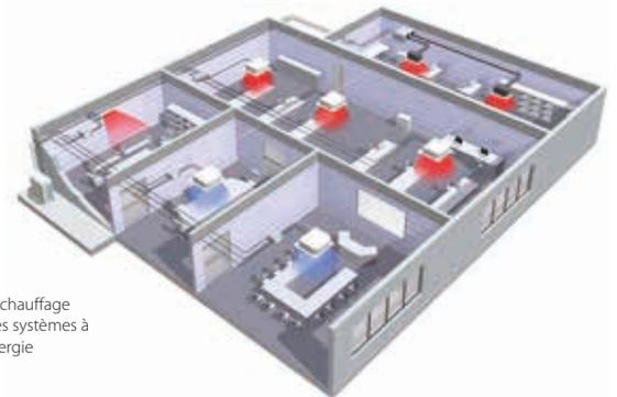
Rafrâchissement/chauffage simultanés avec les systèmes à récupération d'énergie
