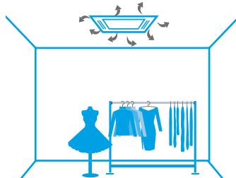
Luchtverdeling met een verontreinigd filter
