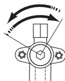
Dans le sens inverse des aiguilles d'une montre pour ouvrir,
