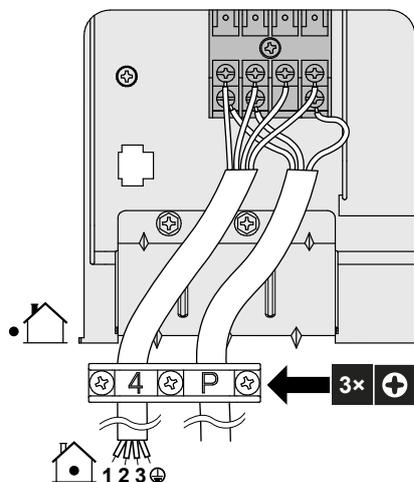
6 Serrez bien les vis des bornes. Nous recommandons d'utiliser un tournevis cruciforme.
