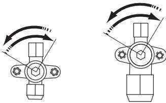
Dans le sens inverse des aiguilles d'une montre pour ouvrir.
