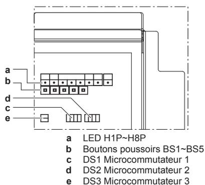
Actionnez les commutateurs et boutons poussoir avec une tige isolée (comme un bic) pour éviter de toucher des pièces sous tension.
