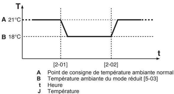
Réduction configurée pour la commande de température de l'eau de sortie
