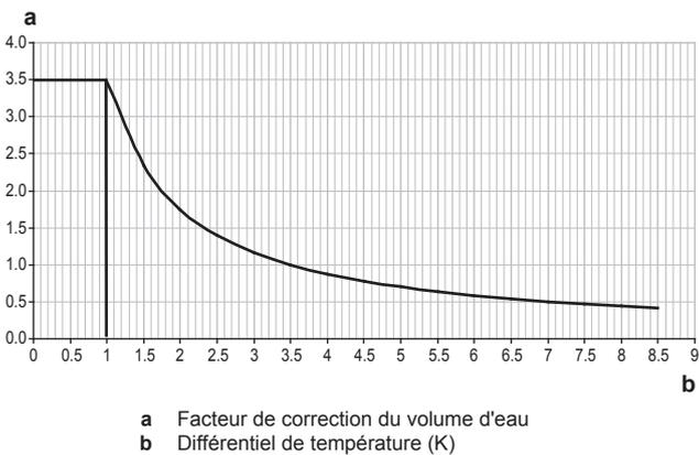
En multipliant 64 l par le facteur de correction, on obtient 224 l, qui correspond au volume d'eau minimum autorisé dans l'installation si un différentiel de température de 1 K est utilisé.
