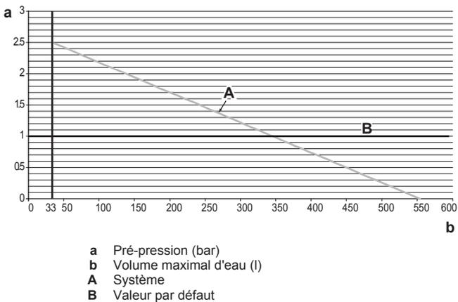
Si le volume d'eau total dans le circuit complet dépasse le volume d'eau maximum admis (voir graphique), un vase d'expansion doit être installé sur la tuyauterie à fournir.
