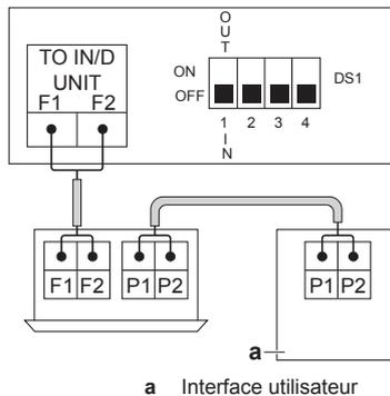
**Commutation entre refroidissement et chauffage avec le sélecteur froid/chaud**
