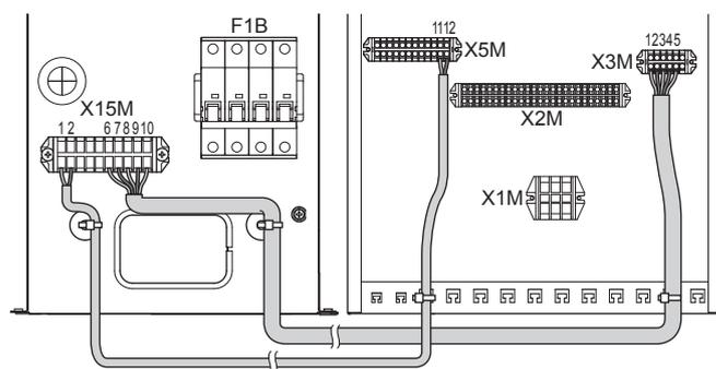
3 Fixez le câble avec les attaches sur les supports d'attaches.
