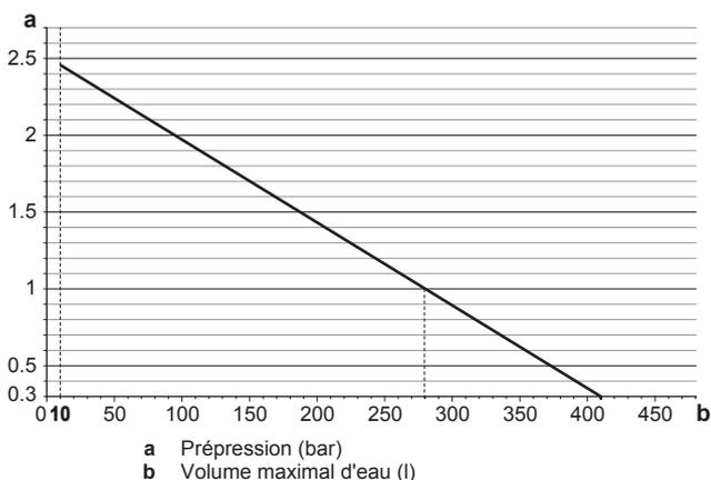
**Exemple: volume maximal d'eau et prépression du vase d'expansion**
