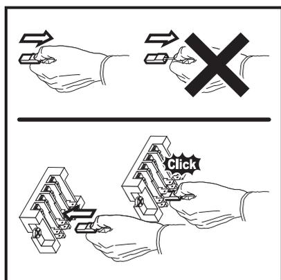
3 Fixez le câble avec les attaches sur les supports d'attaches.
