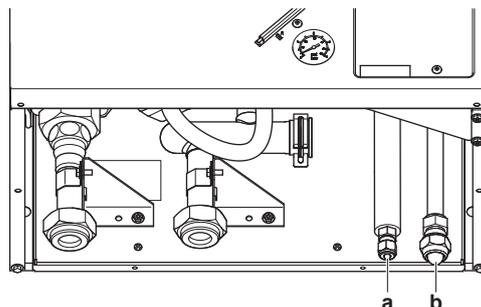
a Raccord du liquide réfrigérant
