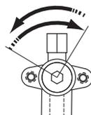
Dans le sens inverse des aiguilles d'une montre pour ouvrir,
