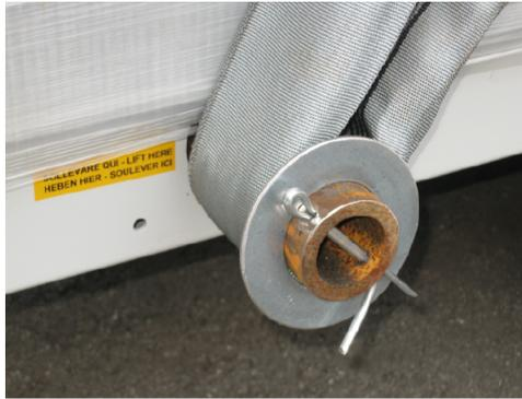
Fig. 3 Détail de l'accrochage de l'élingue au tube de levage
