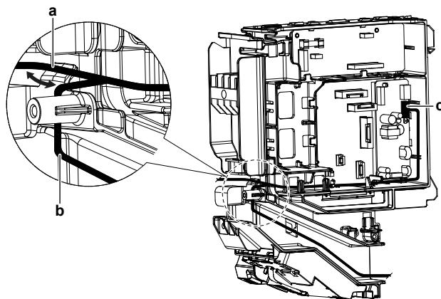
**a** Acheminement du faisceau de câbles S21 pour adaptateur sans fil
