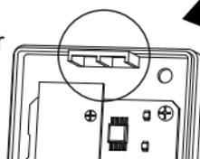
Fermoir situé en haut du boîtier (inférieur) d'adaptateur
